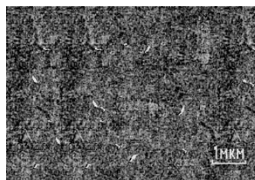
Рис. 4. Примесные микровключения в образцах n-Si<Co>, полученных методом Чохральского.
