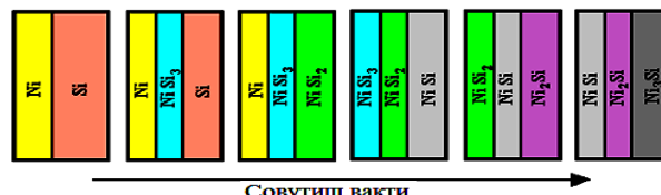
15-расм. Кремнийда никель микробирикмалари ҳосил бўлиши кетма-кетлигининг схематик кўриниши.
