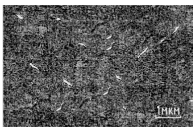
Рис. 3. Примесные микровключения в образцах n-Si<Ni>, полученных методом Чохральского.
