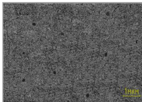
13-расм. n-Si намунаси ҳажмида T=1323 K ҳароратли ТК да ҳосил бўлувчи вакансион ғоваклар.
