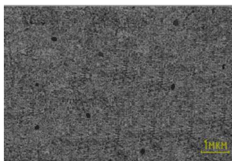
Рис. 13. Микроснимок вакансионных пор, образующихся в объеме образцов n-Si после ТО при T = 1323 К.
