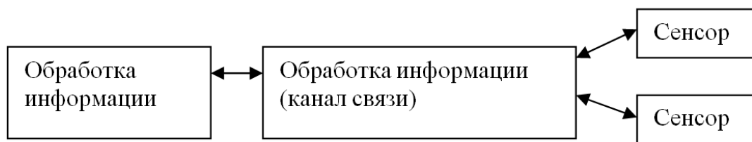
Рис. 1. Функциональная структура системы мониторинга
