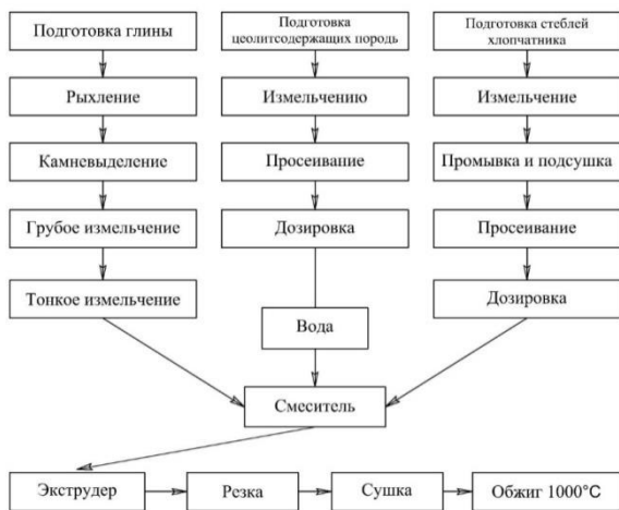
Рисунок 5. Технологическая схема получения эффективных керамических изделий с использованием местного сырья
