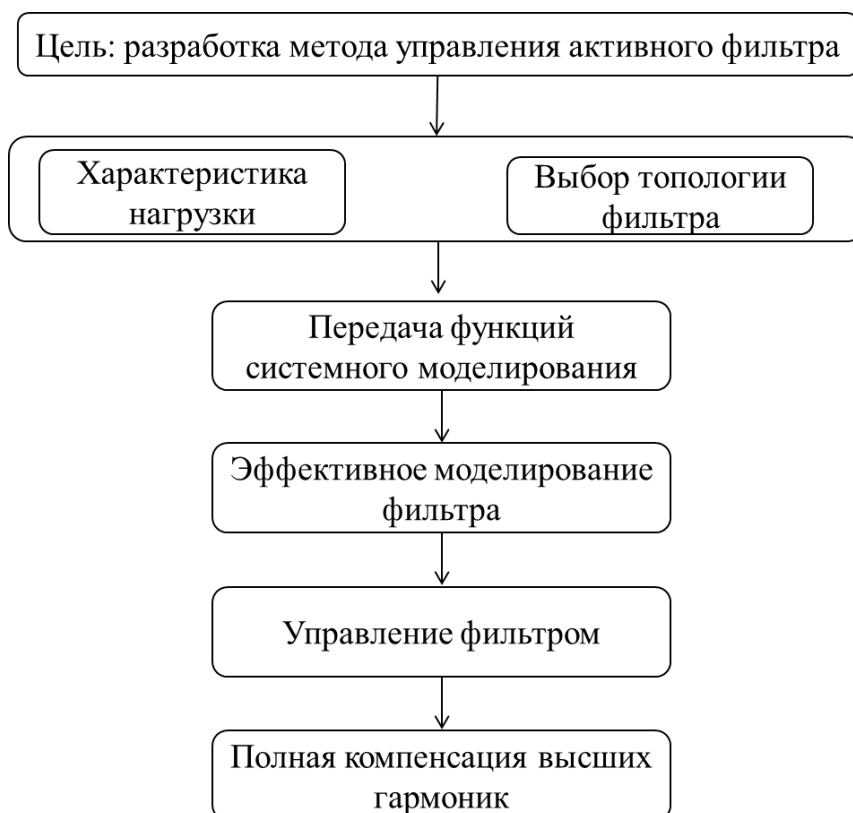
Рис.7. Блок-схема управления качеством электроэнергии
