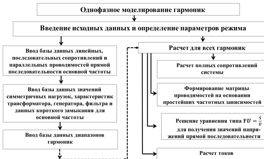
Рис. 1. Структурная схема исследований высших гармоник в однофазной сети
