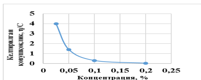
3-расм. 0,1н KCl муҳиtida ГКМАТ:ТетАЛГ комплекси сувли эритмалари қовушқоқлигининг концентрацияга боғлиқлик графиги
