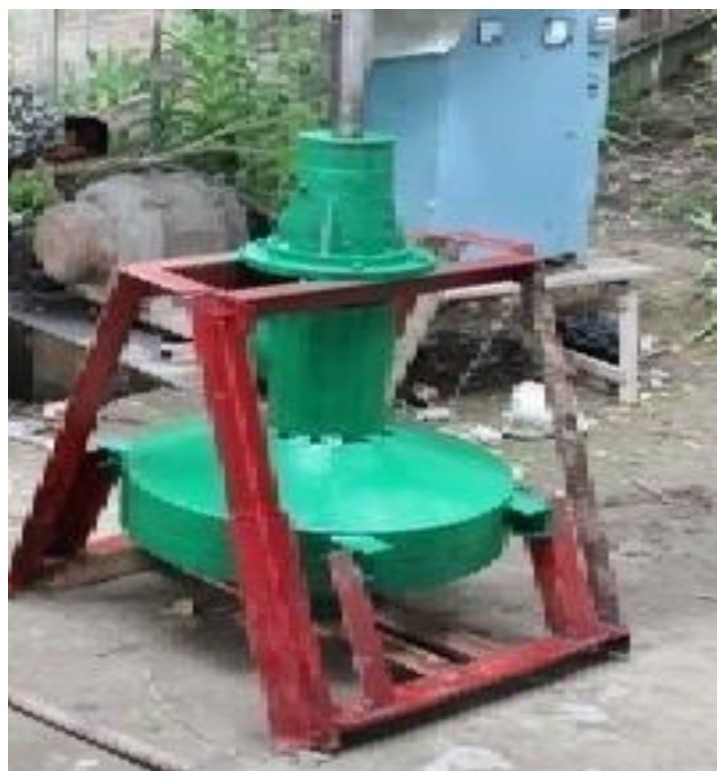
8-расм. Реактив микро-ГЭС тажриба нусхаси.
