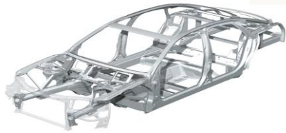
9-rasm. Yengil avtomobil kuzovining karkasi. 1-taq qism, 2-rama, 3-oldingi qism, 4-tom, 5-ustunlar, 6-orqa qismi
