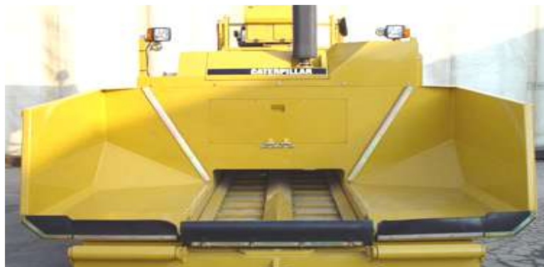
25-расм. Caterpillar AP 600 маркали асфалт ёткизгич машинаси, асфалт қабул қилувчи бункери
