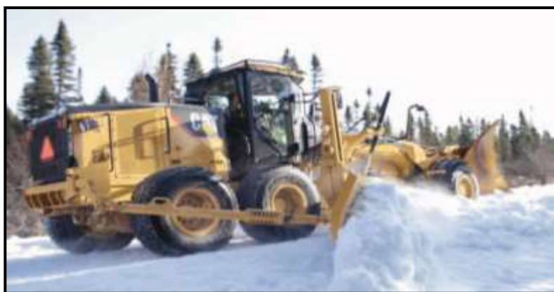
12-расм. Қор курашда қўлланиладиган Автогрейдер ишчи жиҳози.
