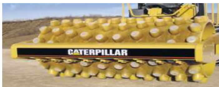
28-расм. caterpillar ap-734 маркаличакик тош ётқизгич зичловчи машина ишчи жиҳози
