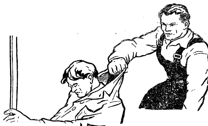
2-расм. 1000В гача бўлган электр токи таъсирига тушган инсонни қурик кейимидан тортиш йўли билан қутқариш.
