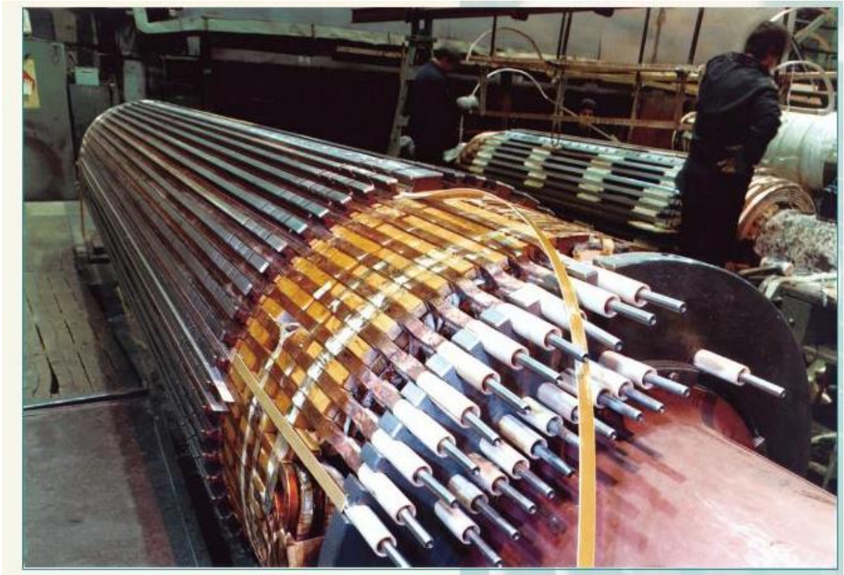
2.2 – rasm. Turbogenerator rotoriga cho‘lg‘amlarni o‘rnatish jarayoni.
