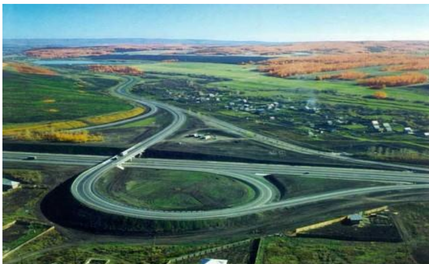
54-rasm. Avtomobil yo'llarini yo'l o'tkazgich asosida har xil sathdagi kesishishi
