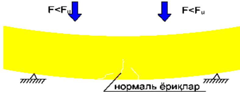
Namuna bo'ylama o'qiga tik bo'lgan dastabki yoriqlarning hosil bo'lishi
