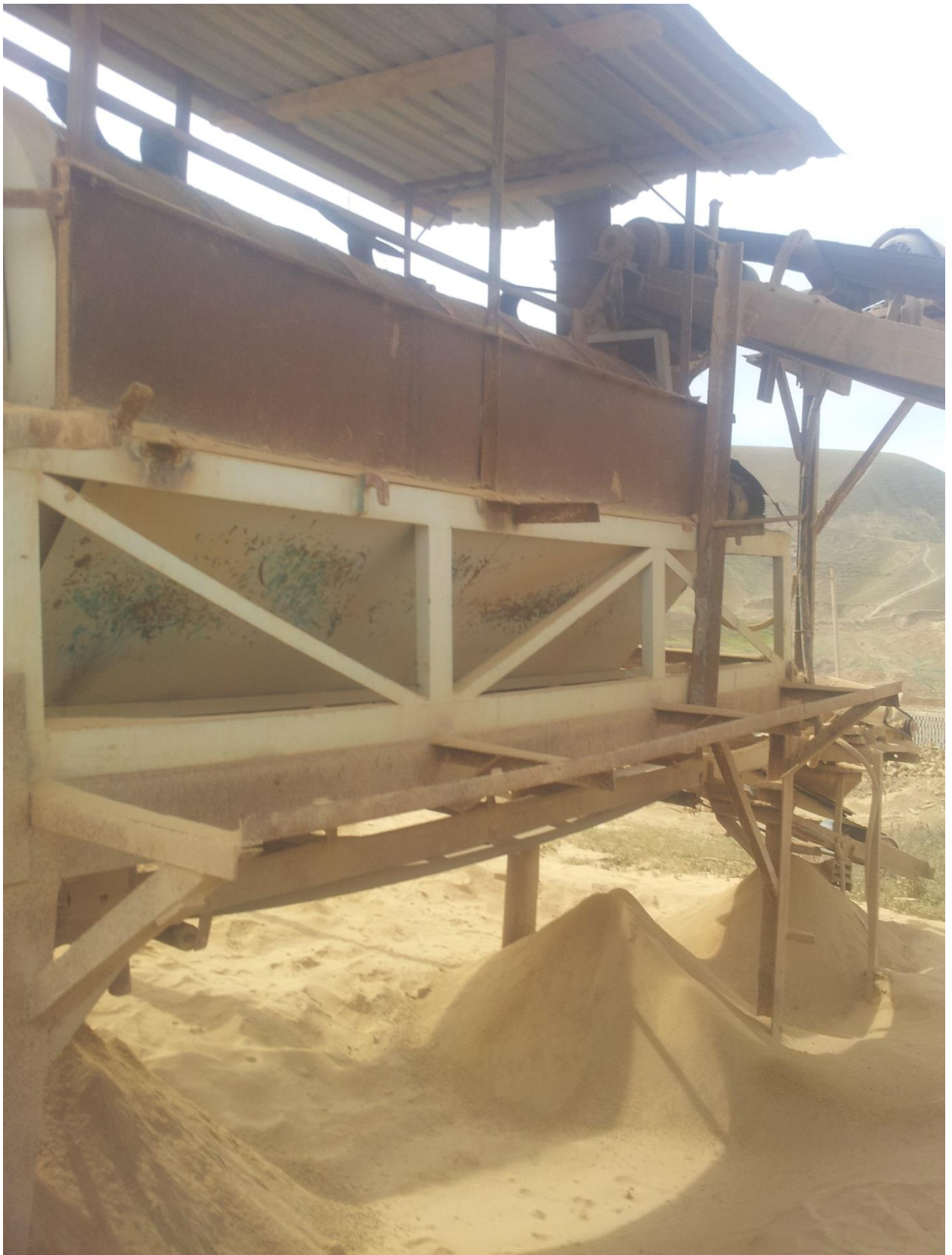
7-rasm. Gil-tuproq va ko‘mir kukuni aralashmasi 1-2- tegirmondan o‘tib elakga kelib tushdi.
