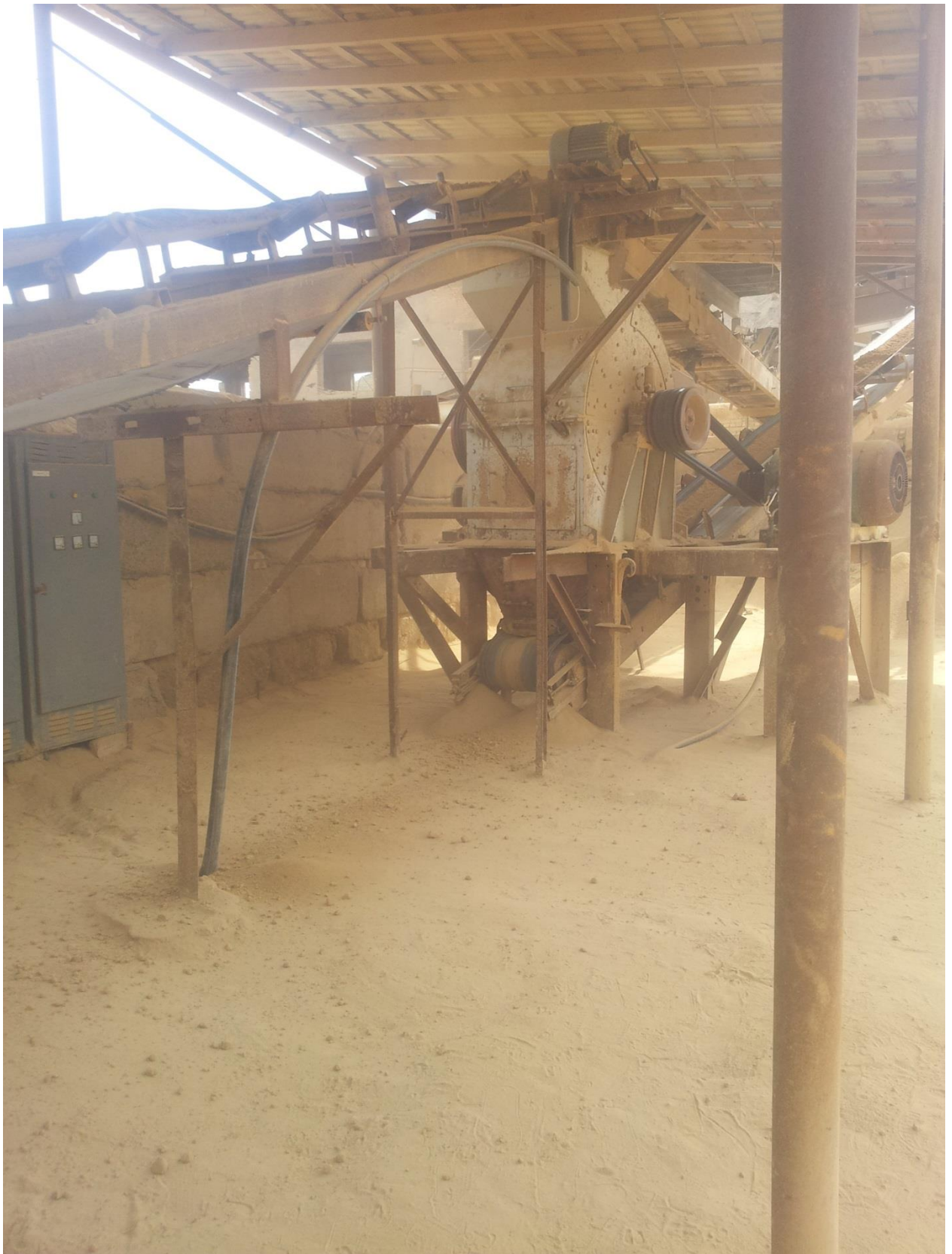
6-rasm. 2-tegirmondan o'tib un xolatiga kelgan tuproq va ko'mir aralashmasi lenta orqali elakga yo'naltiriladi.
