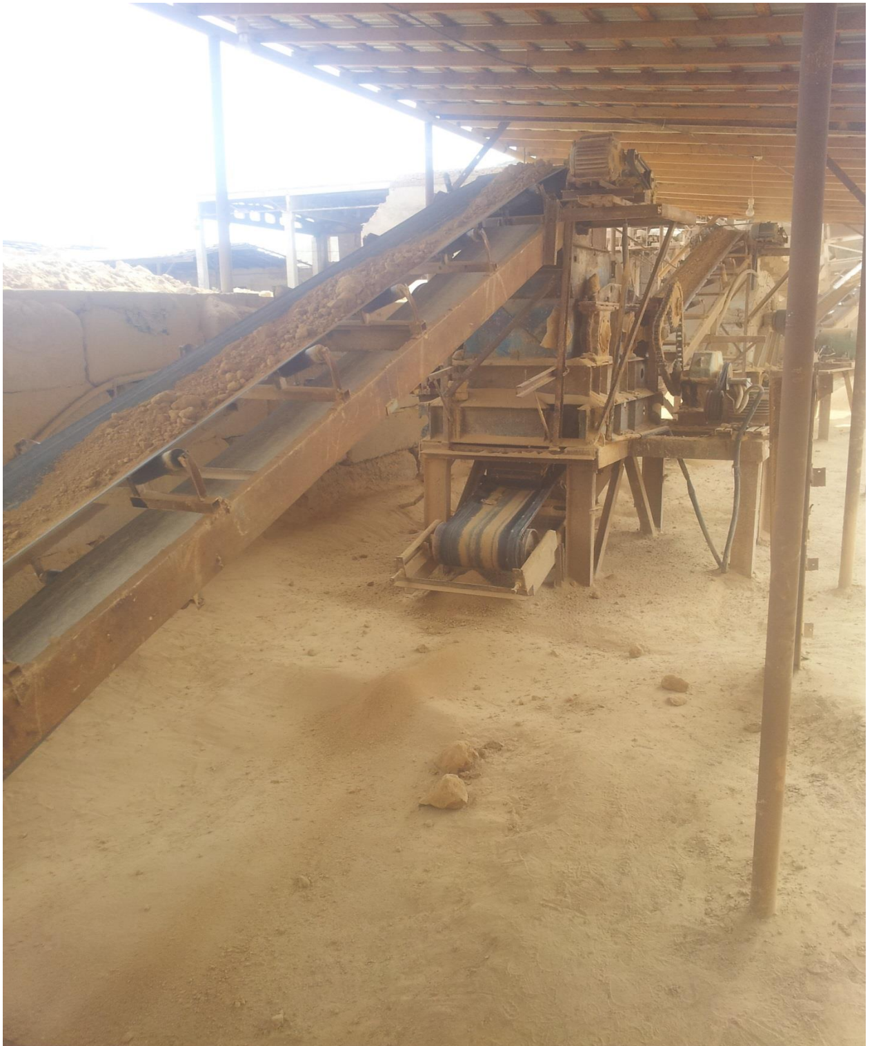
5-rasm. Tuproq va ko'mir aralashmasi lenta orqali maydalash tegirmoniga yo'naltirilishi.
