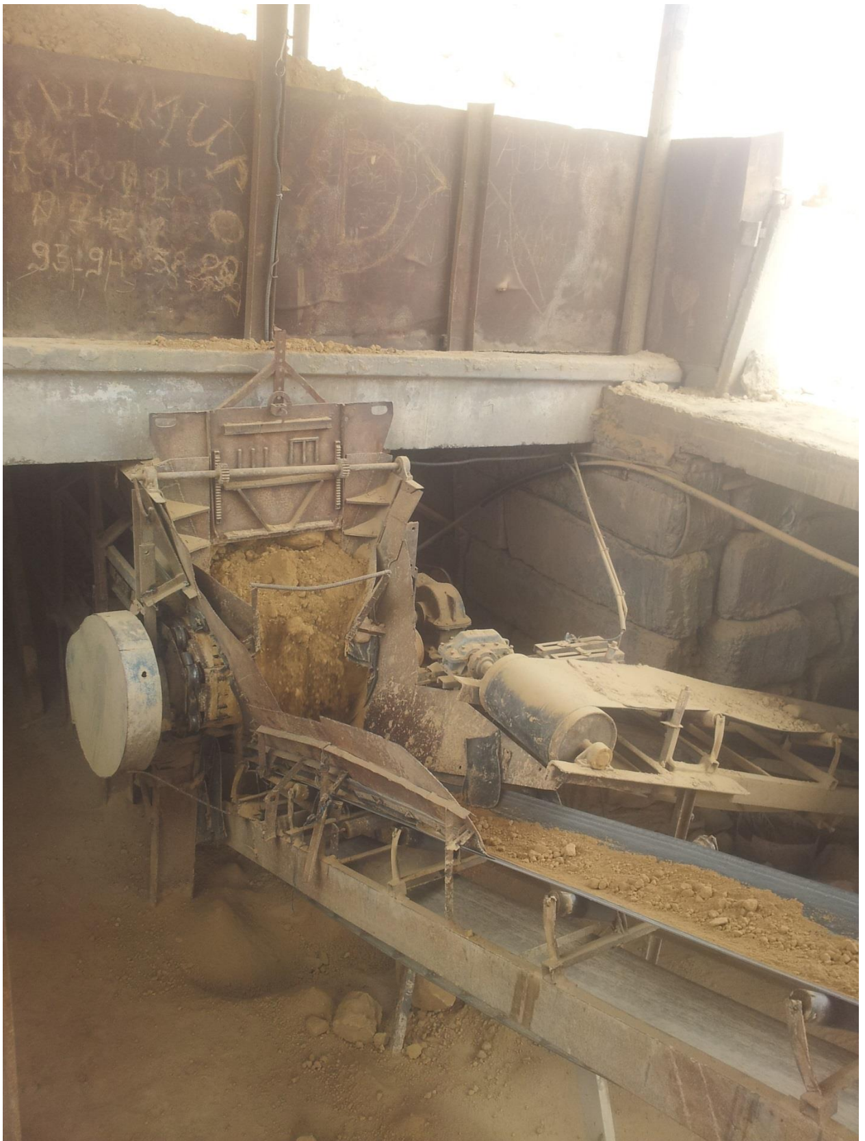
4-rasm. Tuproqni lentaga yetkazish va xar 1000 dona g'ishtga mo'ljallab 130 kg dan ko'mir qo'shish lentasi.
