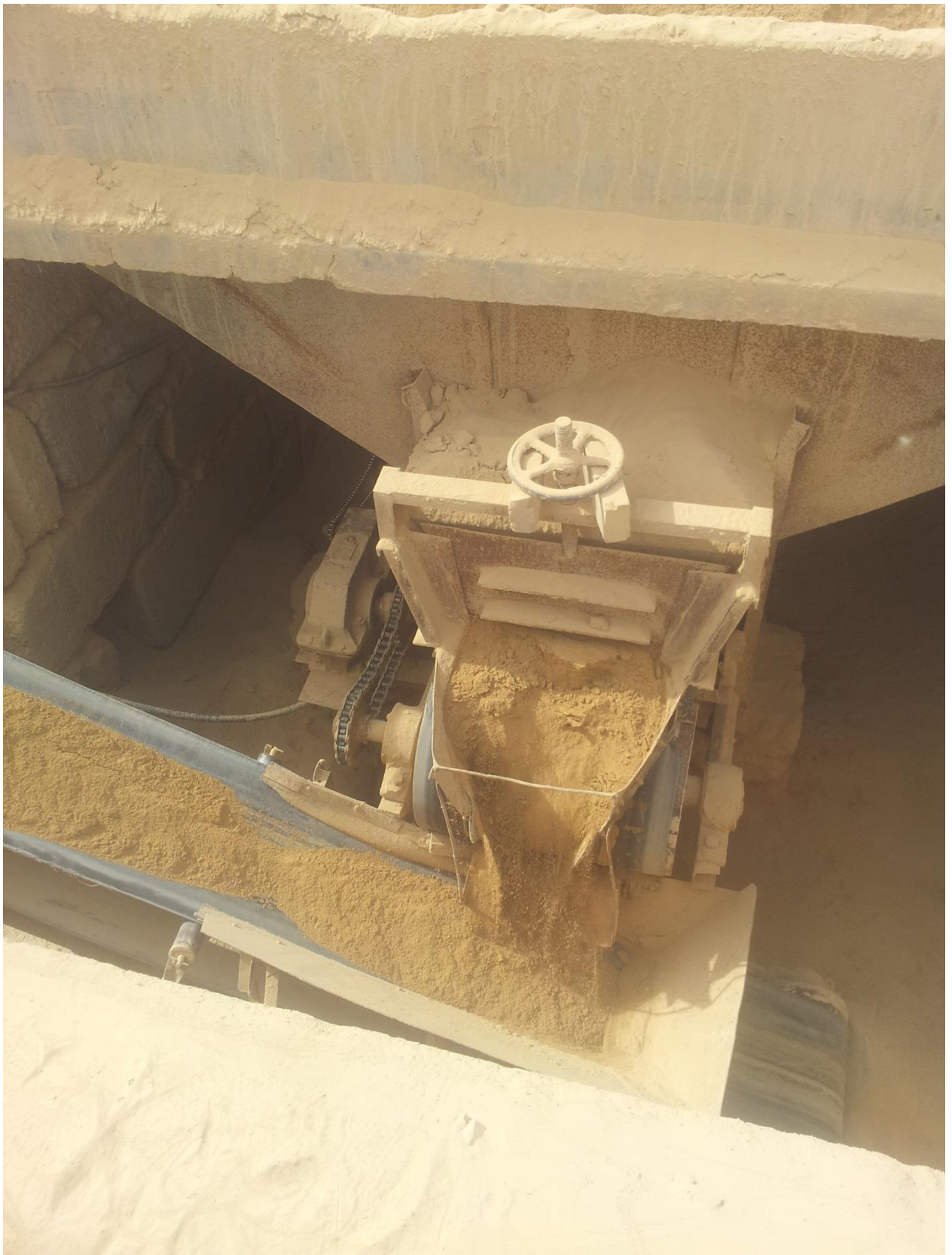
8-rasm. Elakda kukunni mayda xolatiga keltirilgan tuproq aralashmasi lenta orqali loy qorishma bo'limiga yo'naltiriladi.
