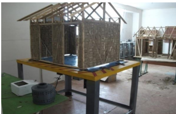
51-расм. 1:5 масштабдаги якка каркасли модел
