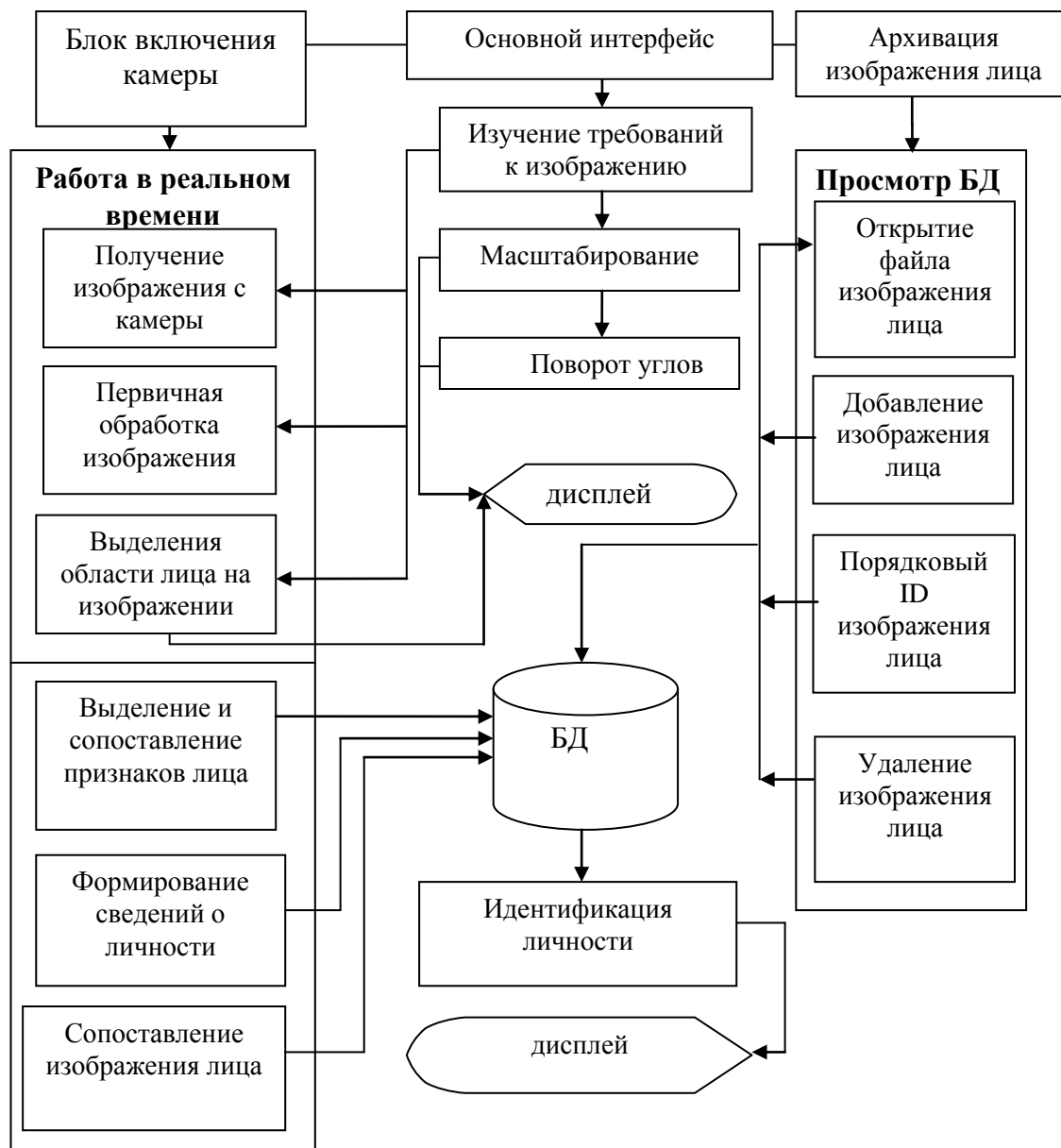
Рис. 7. Функциональная структура программы «Face Identification»
