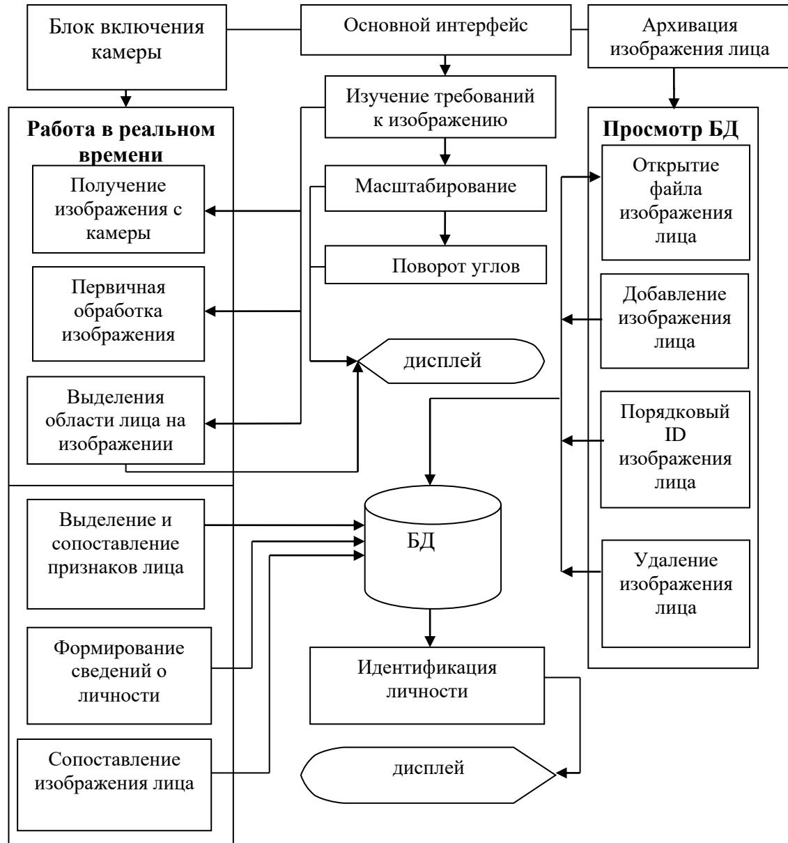
**Рис. 7. Функциональная структура программы «Face Identification»**
