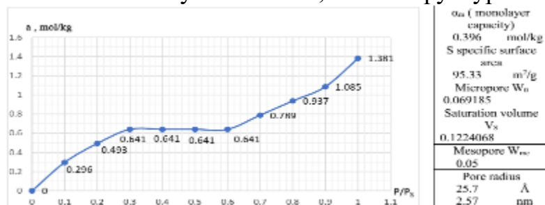
Рис. 12. Изотерма адсорбции паров бензола катена-[натрий аква-(этилендиаминтетраацетат) -железо (III) дигидрат]
