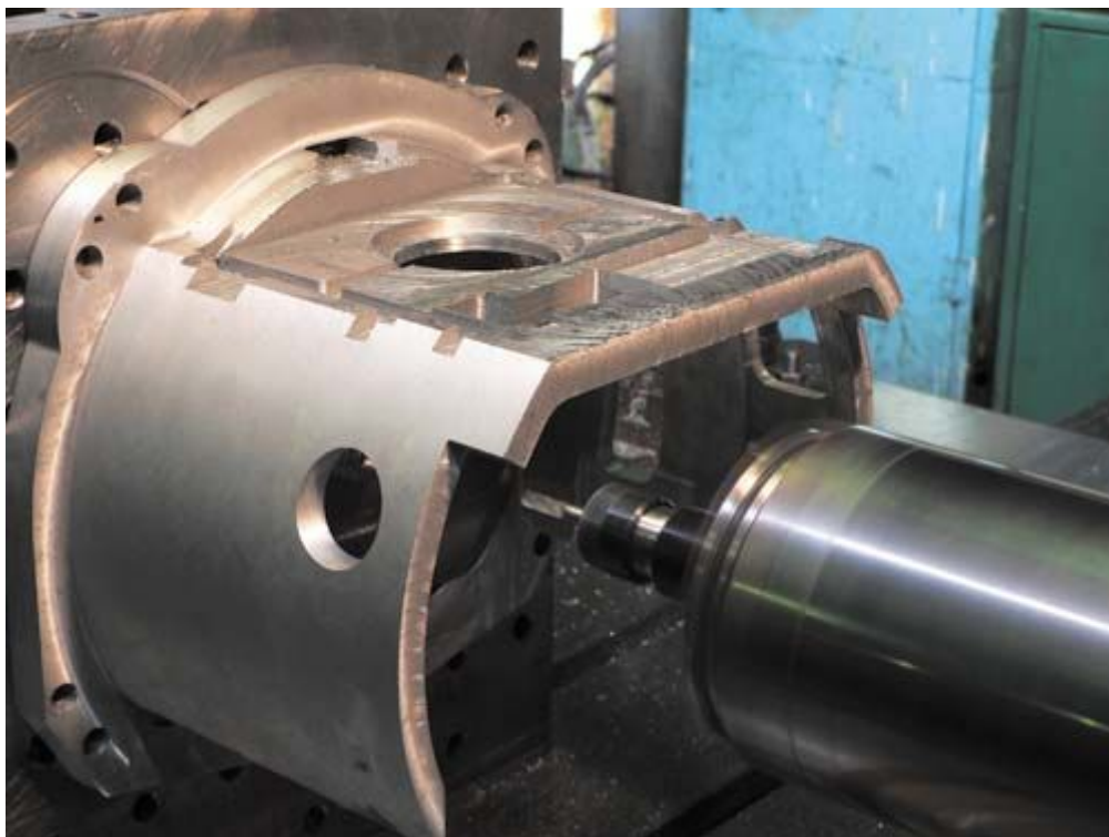
Рис. 7. Корпусная деталь в процессе обработки
