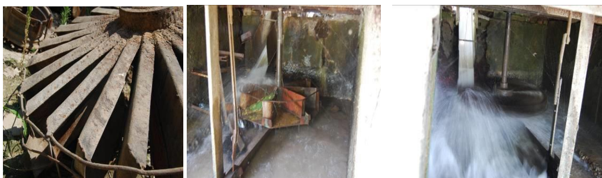
3.6-rasm.Gidroturbina kurakchalarini modernizatsiya qilish bosqichlari. 24 ta kurakcha turbina , 10 ta kurakchaliturbina va oxirgi optimal kurakchali turbina
