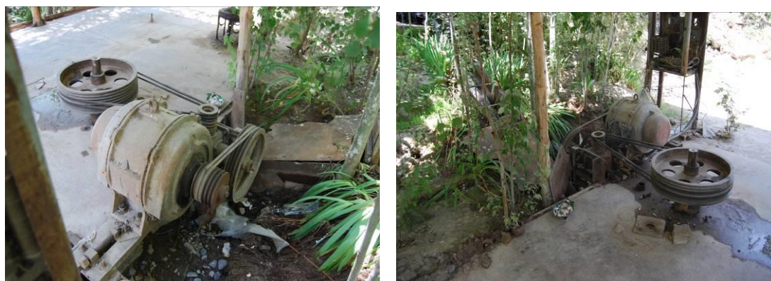
3.7-rasm.Siza mikroGESi reduktori va gidrogeneratori
