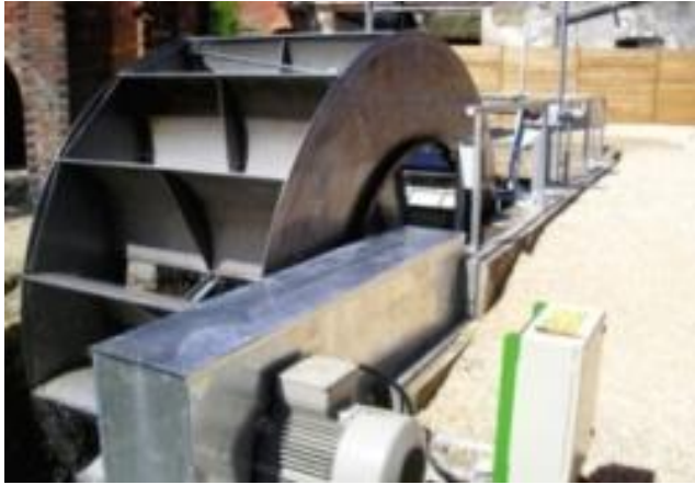
3.2-rasm.Kovshli parrak asosida ishlovchi gidroturbinalar.
