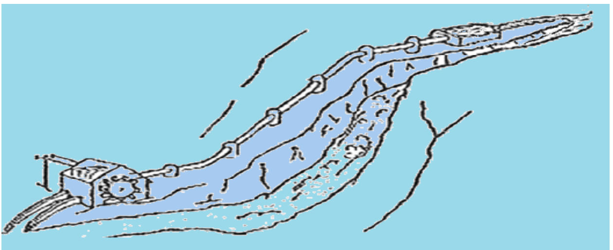
2.7-rasm. Tabiiy bo'lmagan bosimli mikro GES
