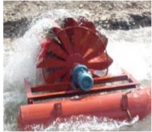
3.2-rasm.Kovshli parrak asosida ishlovchi gidroturbinalar.
