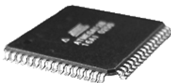
Рис.3.3. Микроконтроллер AVR (Atmel) в планарном корпусе
