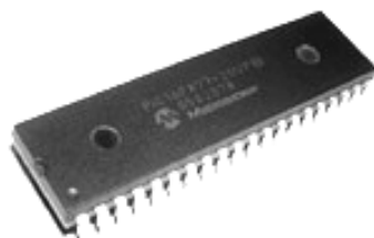
Рис.3.2. Микроконтроллер PIC (Microchip) в корпусе DIP
