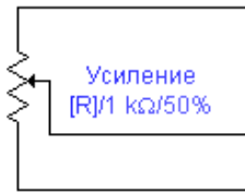
Рис.6.4. Метка «Усиление», присвоенная резистору, чтобы не забыть его назначение в схеме (в данном случае это регулятор усиления схемы).
