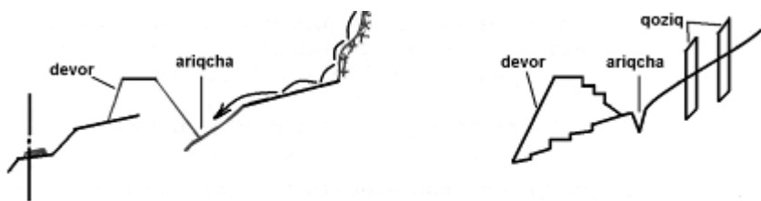
46-rasm. Qiya sathlarda toshlarni ushlab qoluvchi devorlar, qoziqlar va ariqchalar qurish.
