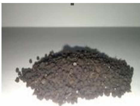
Рис. 4.2. Твердый Са-альгинатный биосорбент на основе биомассы виноградных выжимок.
