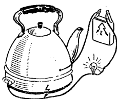
3-расм. Чойнакдаги қисқа туташув ва корпусга ток ўтишини текшириш.
