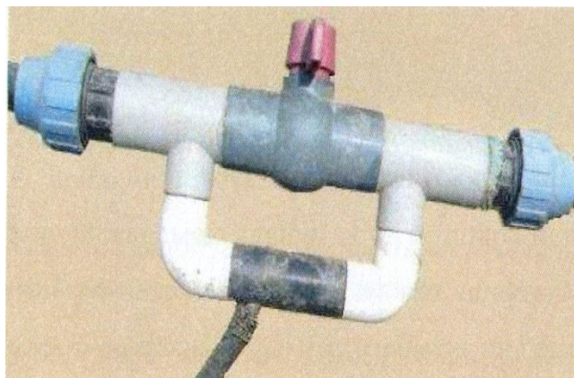
43-расм. Томчилатиб суғориш тизими таркибидаги ўғит етказиб берувчи “Вентури”инжектори
