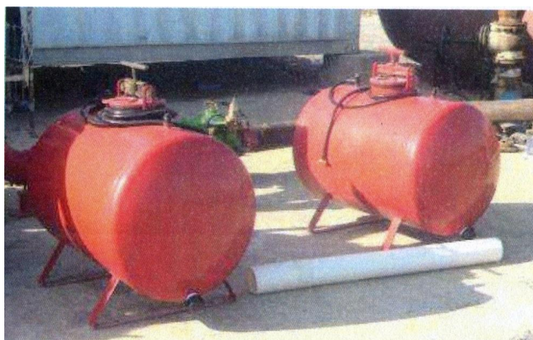
44-расм. Томчилатиб суғориш тизими таркибидаги ўғит тайёрловчи ва етказиб берувчи идиш
