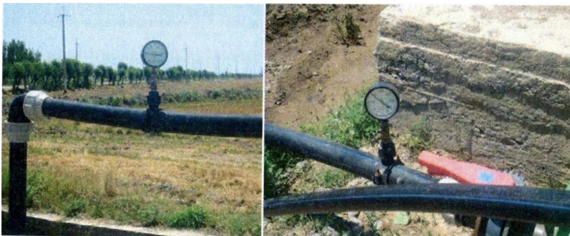
47-расм. Томчилатиб суғориш тизимининг босимни назорат қилувчи манометрлари
