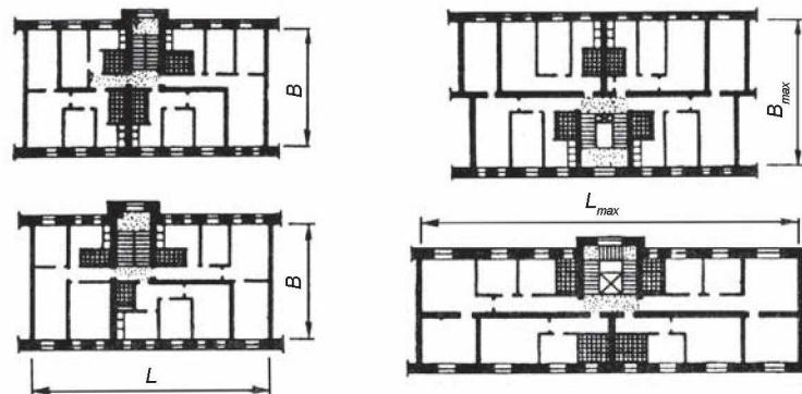
2.1-rasm. Binolarni modernizatsiya qilishda reja yechimlarining qo'llanilishi.
