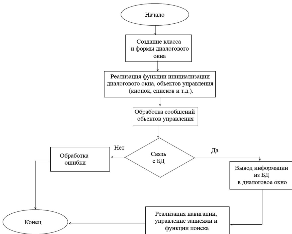
Рис.2.12. Алгоритм работы части «Окно открытие файла БД», приложения информационно-поисковой системы
