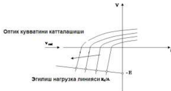
Расм 7. Фотодиоднинг фотоўтказиш ишлаш режими – нагрузка характеристикаси.
