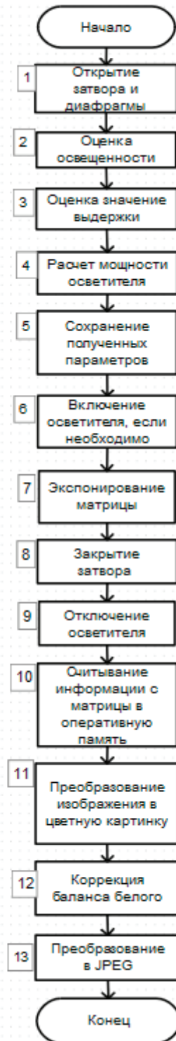
Рис. 7. Блок-схема процедуры съемки
