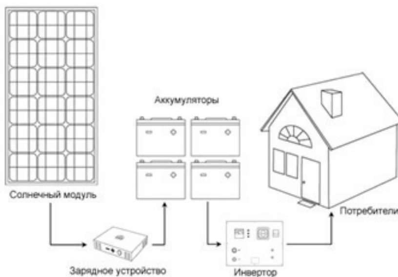
Рис. 2. Принцип работы солнечных батарей
