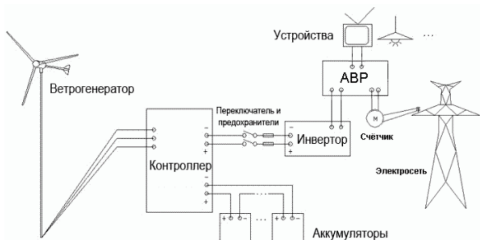
Рис. 1. Схема функционирования ветрогенератора
