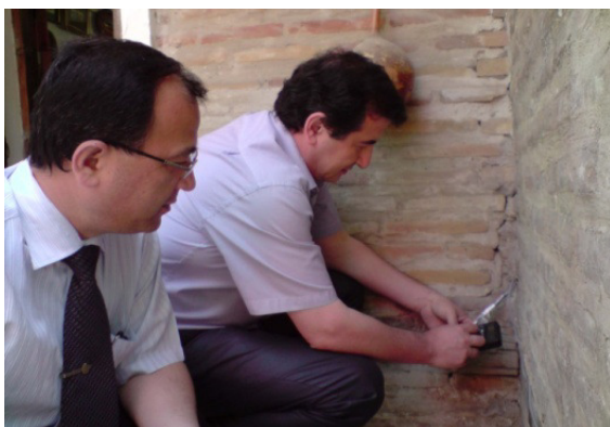
6-расм. «Абулқосим» мадрасасининг деворидан намуна олиниши
