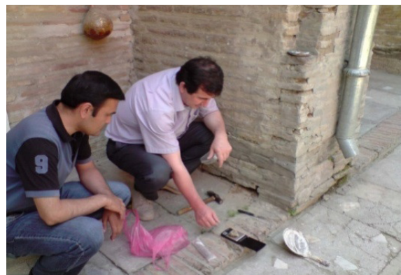
6-расм. «Абулқосим» мадрасасининг деворидан намуна олиниши
