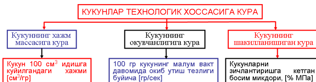
1.6-расм. Куқун материалларини технологик хоссаларга кўра гурухланиш схемаси.
