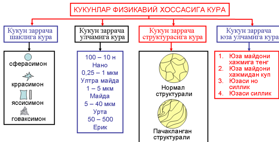
1.5-расм. Куқун материалларнинг физикавий хоссаларига кўра гурухланиш схемаси.
