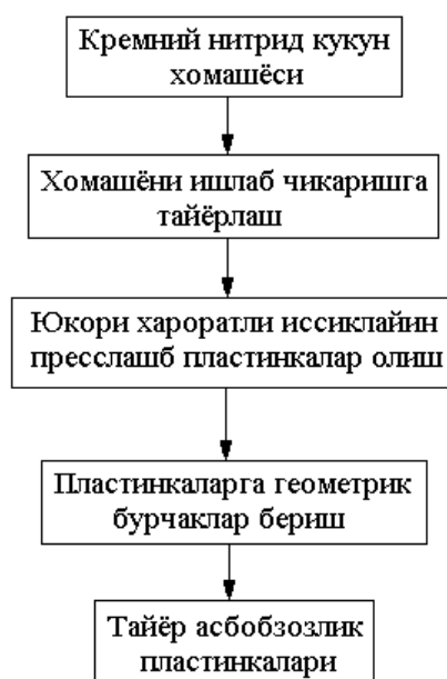
2.1-расм. Кремний нитриддан пластинкалар ишлаб чиқариш технологик жараён боскичлар схемаси
