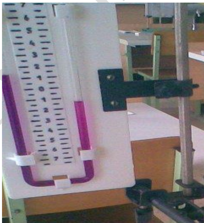
61- расм. Манометрдаги суюқлик шкаласи силжийди.
