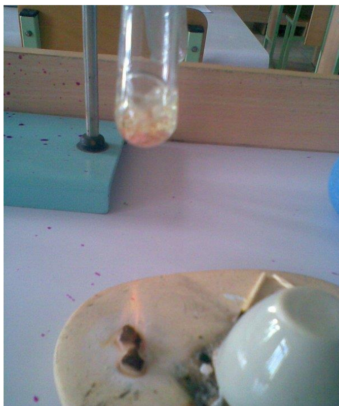
54-расм. Cu ва HCl солинган идишни қиздиргандан сўнг реакцияга киришади.
