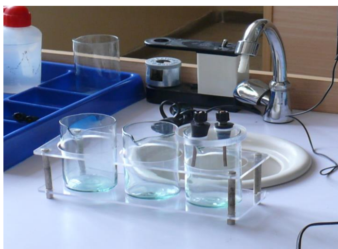
23-расм. H_2O дан электр токи ўтказилганида реакция бормаяпти
