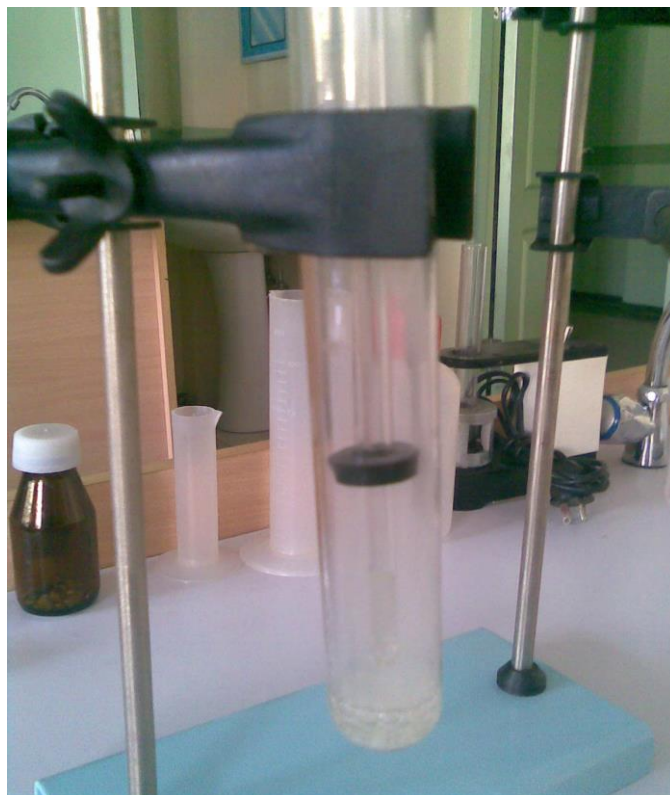
18-расм. Ажралиб чиқаетган H_2 гази совутгич соплога юборилади.
