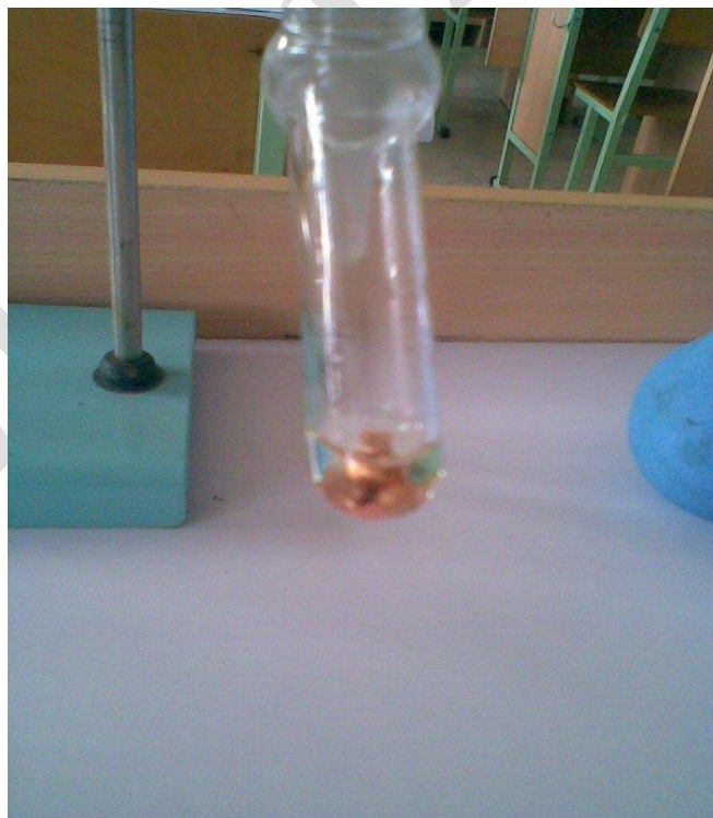
59-расм. \text{Cu} + \text{H}_2\text{SO}_4 билан реакцияга киришади.
