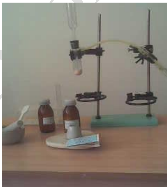
43-расм. Газ ўтказгич най орқали H_2O ли пробиркага солинади.
