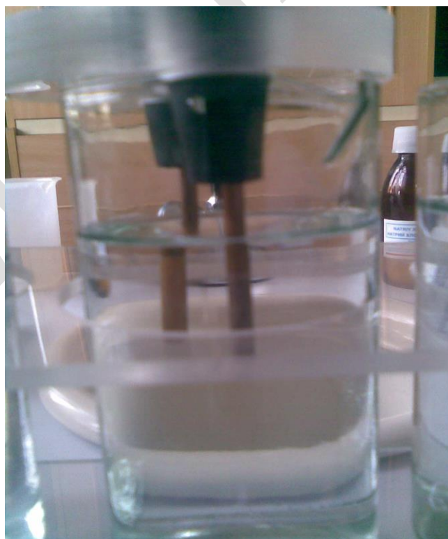
21-расм. Электрот таъсирида эритмада оксидланиш қайтарилиш процесси кетаяпти
