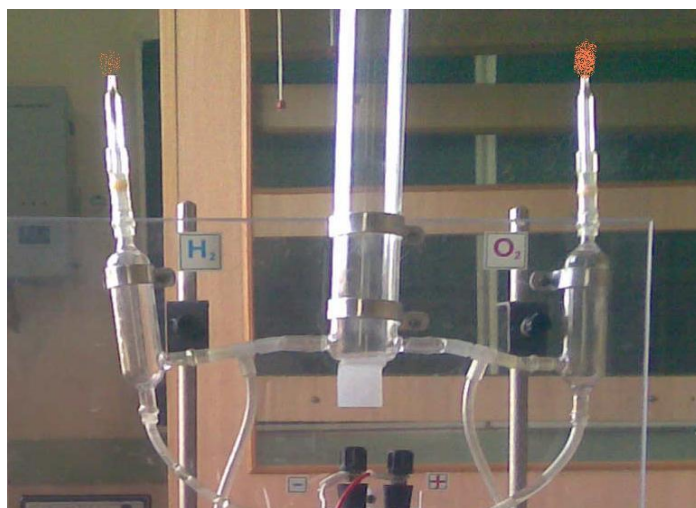
22-расм. Асбобнинг ўнг тамонида O_2 ва чап тамонида H_2 ҳ-л бўлади.
