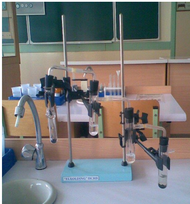
47-расм. \text{HCl} - \text{KMnO}_4 билан реакцияга киришяпти.
