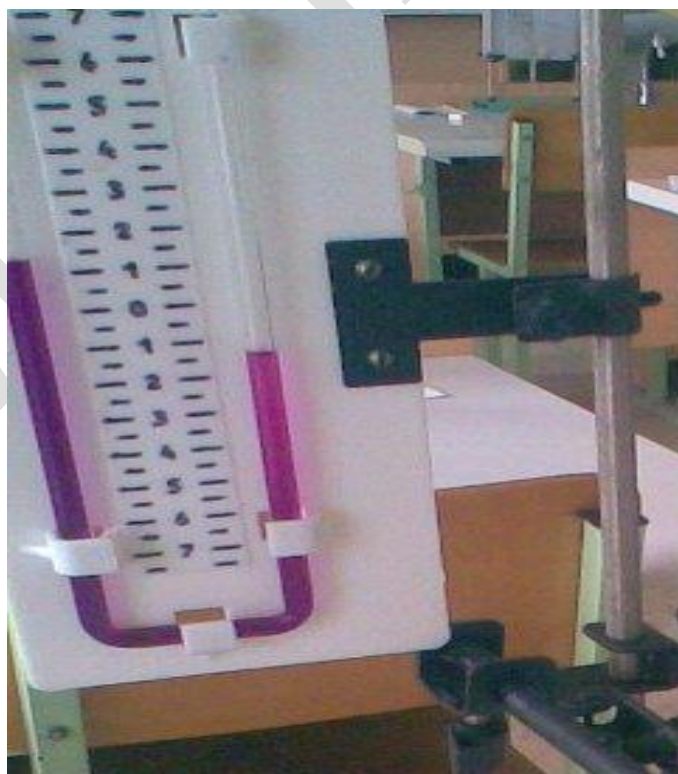
55-расм. Манометр шкаласидаги суюқлик силжийди.
