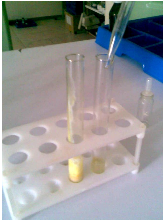
10-расм. 2-пробиркадаги оксилга NaOH ва \text{CuSO}_4 солинади.
