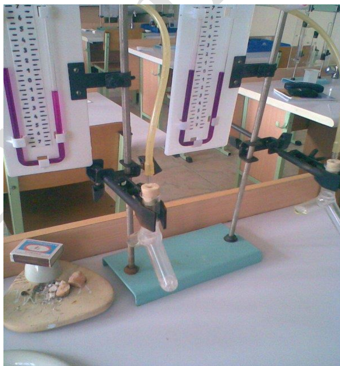
53-расм. Манометр асбобдаги суюқлик H_2 ҳисобига силжийди.
