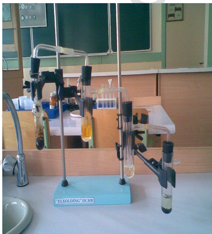
48-расм. Ажралиб чиқаетган \text{Cl}_2 ва \text{Br}_2 ни эритмадан сиқиб чиқаряпти.
