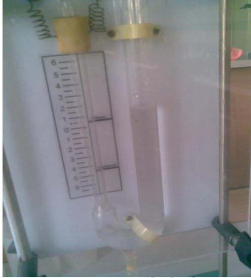
3-расм. H_2O сатхи H_2 кўрсаткигичгача туширилади.
