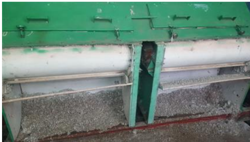
15-расм. Ишлаб чиқилган тола тозалагичда ишлаб чиқариш синовларини ўтказиш жараёни.
