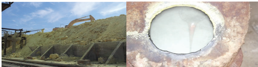
13-расм. а) Олтингургурт омбори; б) Олтингургуртнинг суюк ҳолатда қувурда оқиши тасвирланган.
