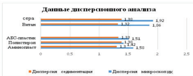
Рис.2. Выражен дисперсионный \sigma анализ порошка аминокласта, эмульсии полистирола, АБС-пластика, витана, серной пыли.
