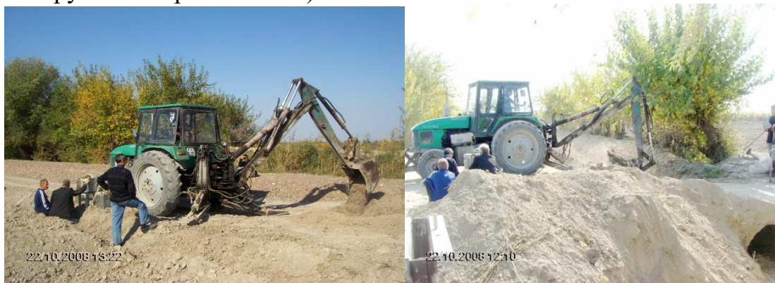
Рис. 12. Экспериментальный процесс прототипа машины на базе трактора ТТЗ-80.10 по экскавационных оборудований копания траншей и оросительных сетей
