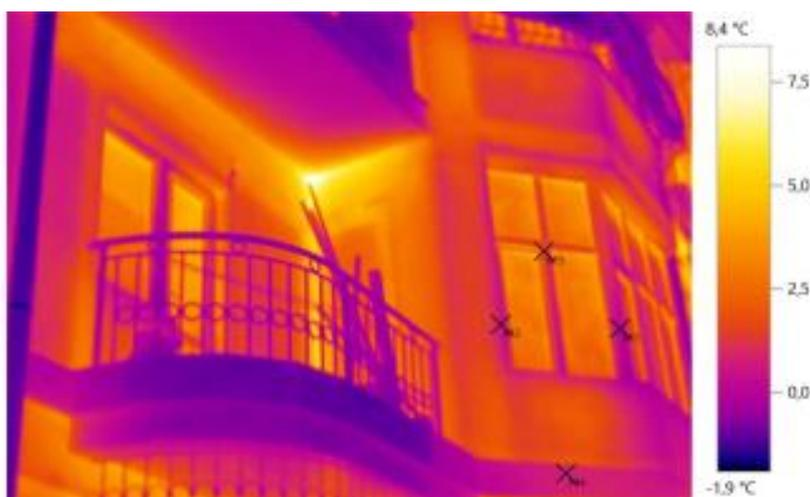
**Рис.1. Термограмма фрагмента фасада с конструкцией сопряжения стены с балконной плитой**
