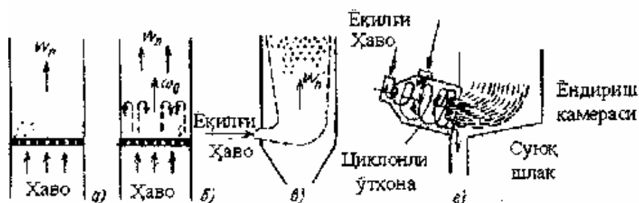
1-rasm. Qattiq yoqilg'i o'txonalari tasnifi: a) qatlamli usul; b) qaynayotgan qatlamli usul; v) mash'alali usul; g) uyurmali usul.
