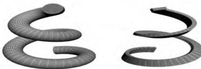
26-rasm. Bir xil splayn (chapda) va to'g'riburchak (ung) kesim tipi. Radial (Округлый) dumaloq splayn kesimini tanlanganda enini tartibga solinadi.
