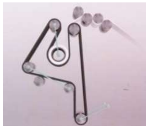
2) O'rash jarayonining boshlanishi, g'altakdagi birlashtirilgan piltalarni pnevmatik uchlash
