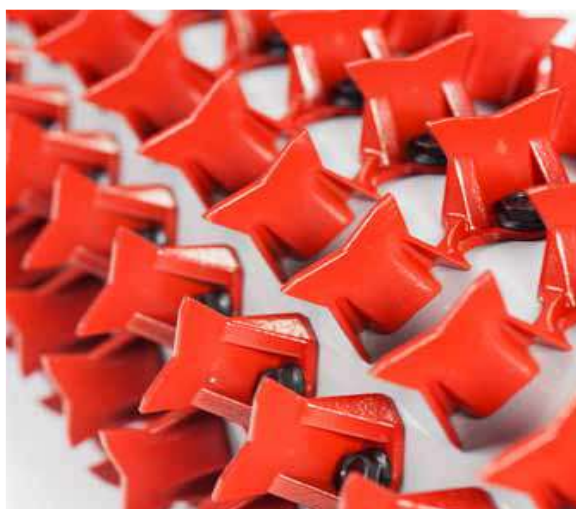
3.9-rasm UNiflos A11 toy tituvchi mashinasining tituvchi barabanga o'rnatilgan tishlarning geometriyasi.
