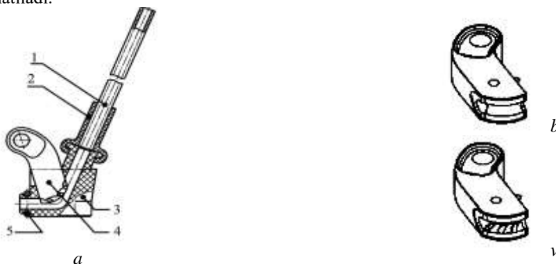
Buram saqlagich moslamasi- a , silliq sirtli- b , o'yiqli sirtli- v ip o'tkazgich.
