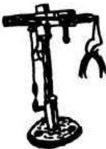
51-расм. Каноп толаларининг оғирлигини аниқловчи тарози.
