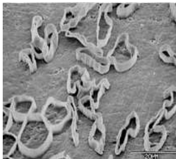
35-расм.Пахта толаси девор қатламининг шаклланиши (пишмаган тола).
