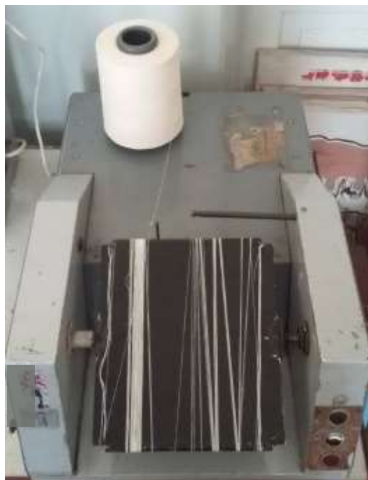
59-расм. Ипнинг тозалигини аниқловчи МОК приборининг тасвири.
