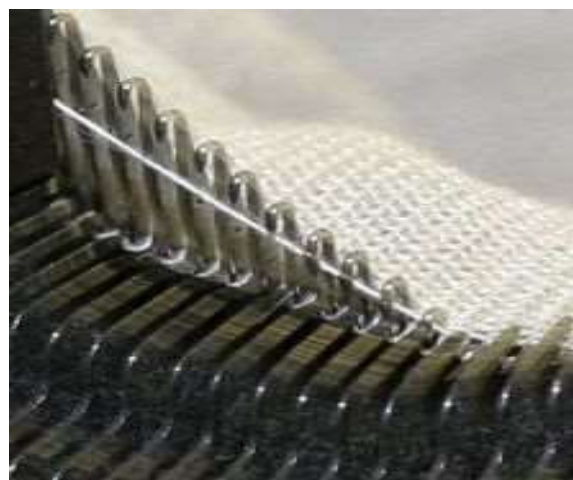
70-расм. Трикотаж тўқув машиналарида халқа ҳосил қилиш жараёни.
