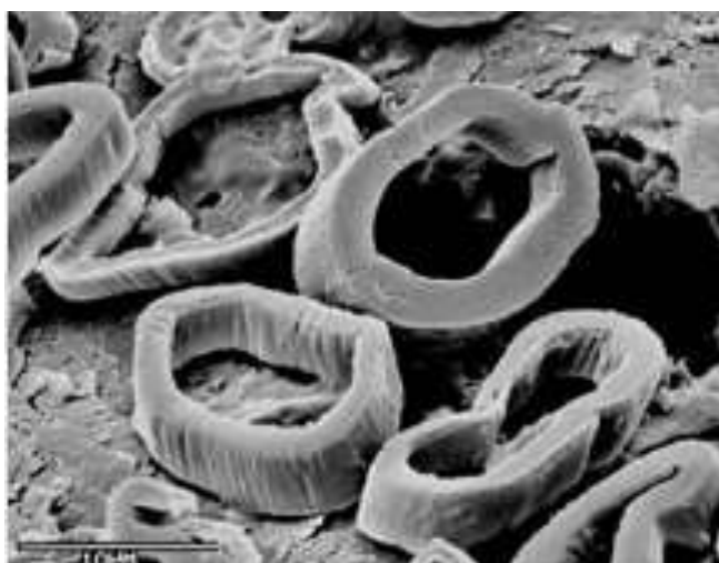
36-расм.Пишган пахта толаларининг микроскопдаги тасвири.
