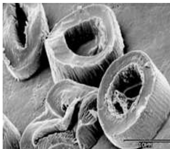
36-расм.Пишган пахта толаларининг микроскопдаги тасвири.
