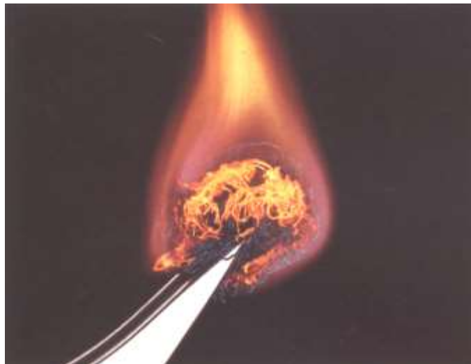
15-расм.Аланга таъсиридаги тола.
