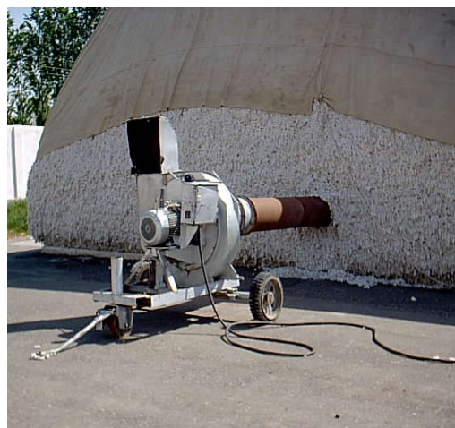
3.6-rasm. UVP rusumli ko'chma ventilyatorning qurilmasi va g'aramga o'rnatilishi.
