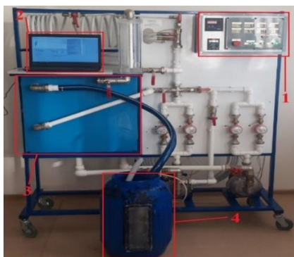
6-расм. Модернизация қилинган лаборатория стендининг схемаси, тажриба ускунасининг гидрокинематик схемаси ва «Марказдан қочма насослар» СГУ-ЦНС-012-6ЛР-ПК - насос модели
