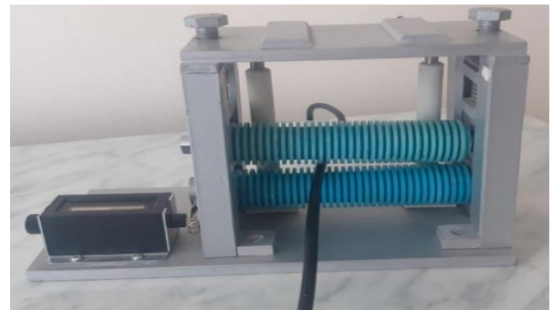
1,2 – подвижные и стационарные ролики; 3 – прижимная пружина; 4 – фиксатор; 5 – подшипники; 6 – передача; 7 – одомер
