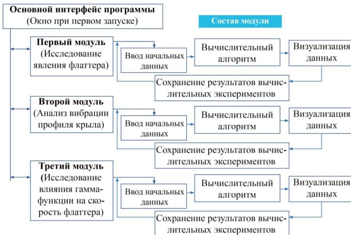
**Рис. 9. Архитектура программного комплекса.**
