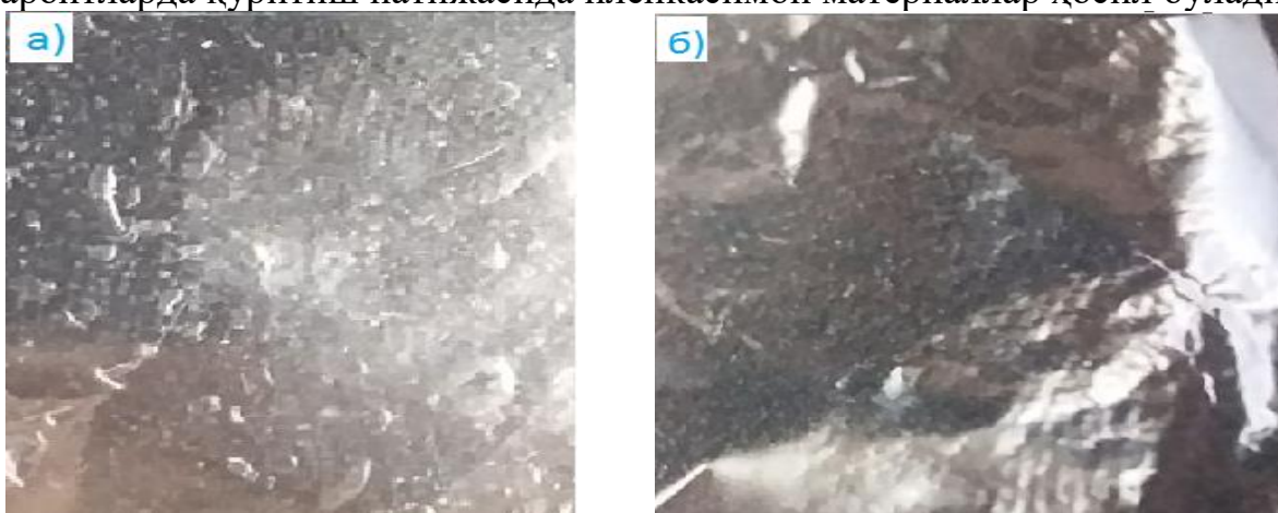
6-расм. Na-КМК эритмасига ZnSO_4 эритмаси қўшиш орқали олинган полимер плёнкасининг ташқи кўриниши. А) 0,025 М ZnSO_4 қўшиш орқали олинган плёнка; Б) 0,05 М ZnSO_4 қўшиш орқали олинган плёнка.
