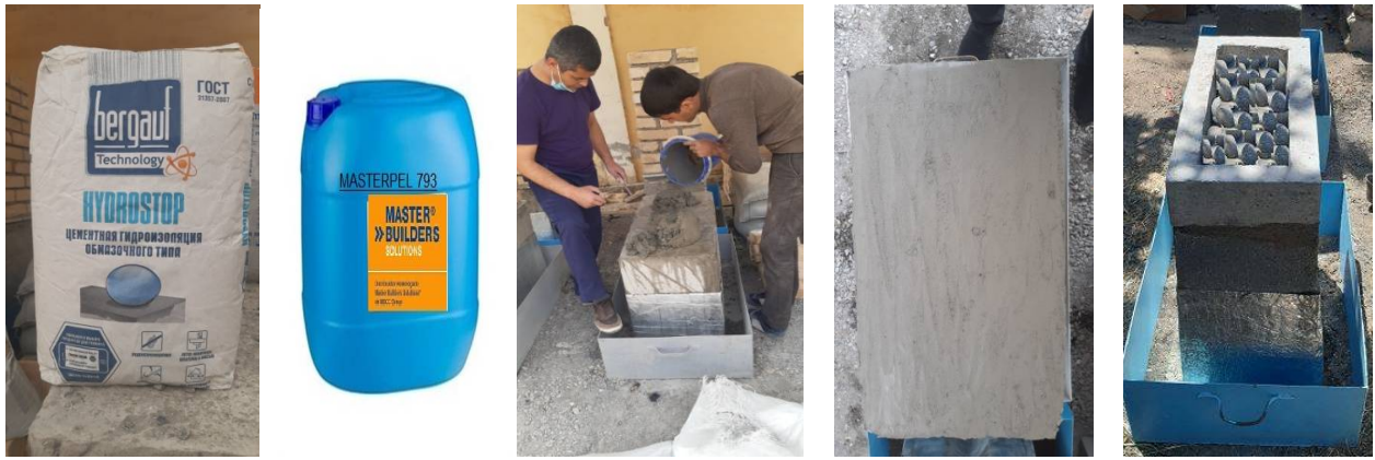
Рис. 2. Материалы, использованные для изготовления испытательных образцов
