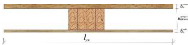
4-расм. Кўштавр кўндаланг кесимли енгил ёғоч том ёпма панелнинг ҳисобий схемаси
