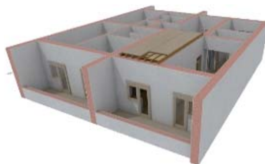
2-расм. Кам қаватли турар-жой биноси ёпмасида энергиятежамкор панел конструкциясини монтаж жараёни
