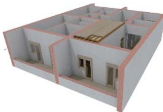
Рис.2 Процесс монтажа конструкции энергосберегающего панеля покрытия для малоэтажных жилых зданий.
