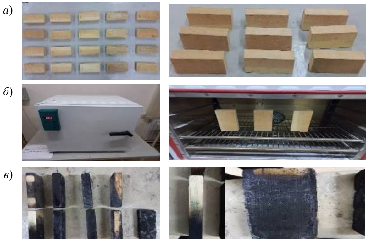
17-расм. Намуналарни оловбардошлилигини ошириш бўйича тажриба синовлари жараёни: а) Ёғоч намуналар; б) Намуналарни қуритиш жараёни; в) Тажриба синовидан кейинги намуналарнинг кўриниши
