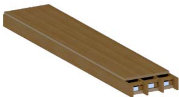
1-расм. Томёпма ва ораёпмалар учун инновацион енгил ва энергиятежамкор панел конструкциясининг умумий кўриниши
