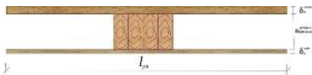
Рис.4. Расчетная схема легкой деревянной панели покрытия двутаврового сечения
