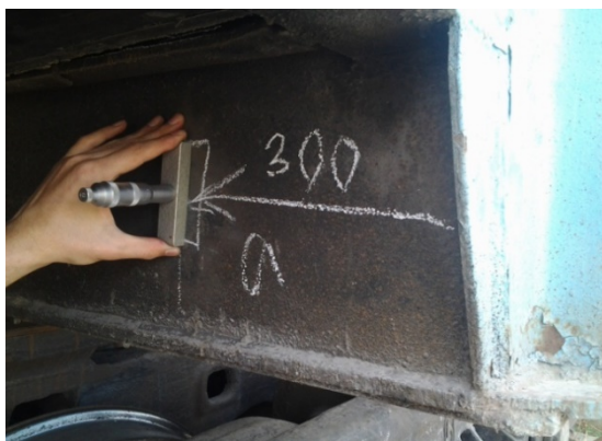
4-расм – Тарози текшириш вағони рамасининг шкворен балкасини ўлчаш
