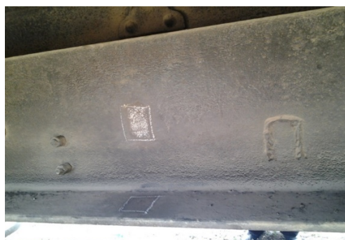
3-расм – Тарози текшириш вағони рамасининг хребет балкасини ўлчаш
