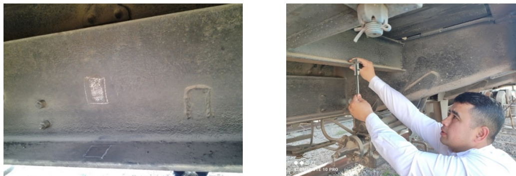
Рис.3. – Замер хребтовой балки рамы несоповерчного вагона
