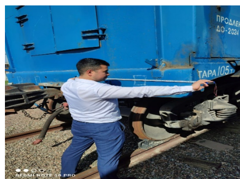
Рис. 5. Замер балки конечной (задней) части рамы несоповерочного вагона
