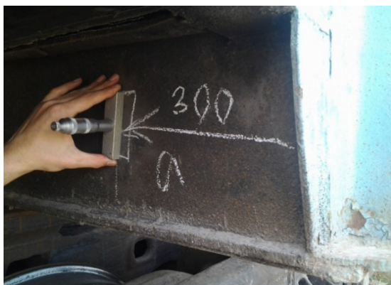
Рис. 4. Измерение шкворневой балки рамы несоповерочного вагона
