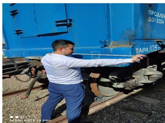
5-расм – Тарози текшириш вағони рамаси уч (орқа) қисм балкасини ўлчаш
