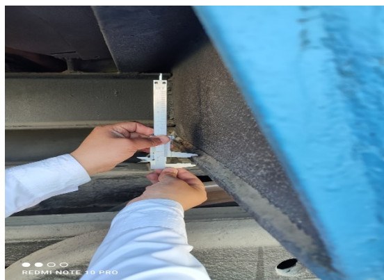
4-расм – Тарози текшириш вағони рамасининг шкворен балкасини ўлчаш
