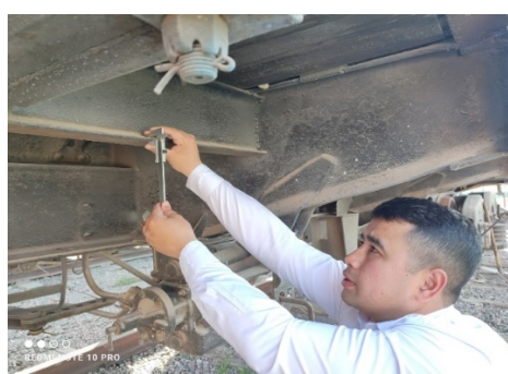
3-расм – Тарози текшириш вағони рамасининг хребет балкасини ўлчаш
