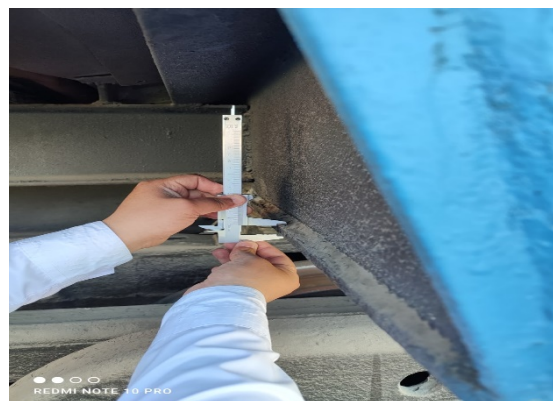
Рис. 4. Измерение шкворневой балки рамы несоповерочного вагона
