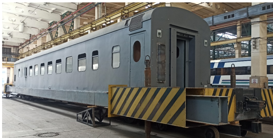
Рис. 7. Общий вид опытного образца динамометрического вагона модели 61-907-ДМ на стенде для нагружения продольными статическими нагрузками
