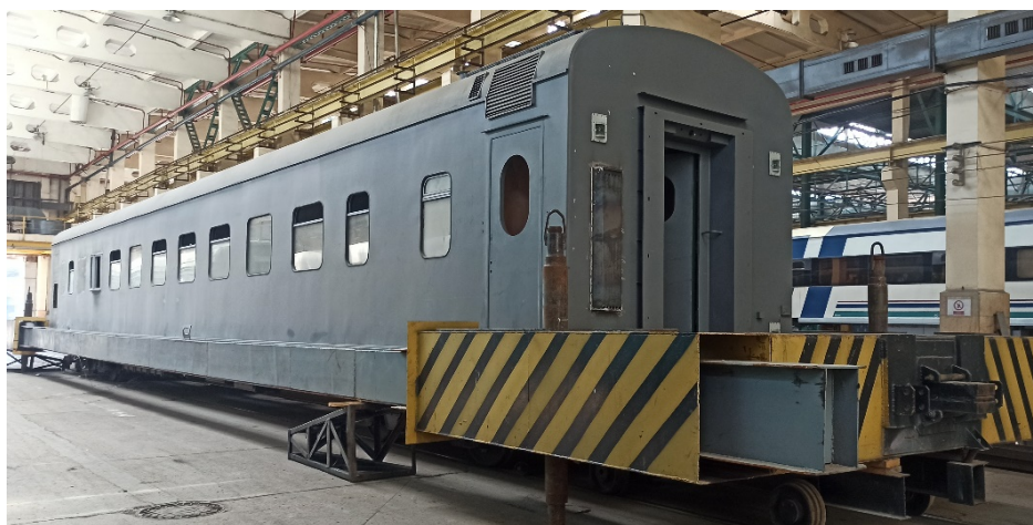
7-расм. 61-907-ДМ русумли динамометрик вагон тажрибали намунасини бўйлама статик юкламаларни қўйиш учун стендаги умумий кўриниши
